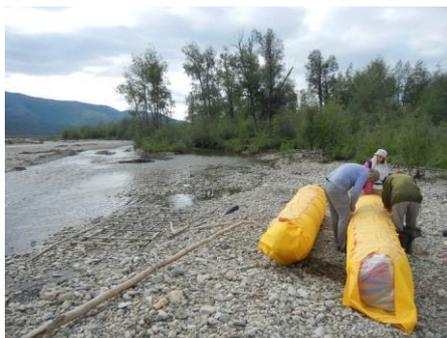
Надувные элементы – ПВХ мячи диаметром 107 см, по китайской рекламе. На самом деле – около 60-70 см. Для крепления рамы использовалась резина от автомобильной камеры. На реке Маякан углы рамы были усилены стяжками. Вес вместе с веслами, крепежным материалом и ремнабором составил 12 кг. То есть на пешей части похода по три дополнительных килограмма на человека.
