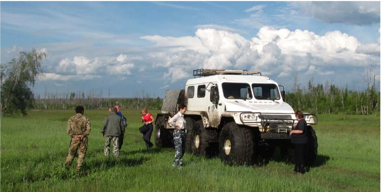
Машина вызывает уважение. При мощности всего в 80 л.с. на 6-ти ведущих колесах с шинами низкого давления мы легко проехали и по грязи, и по залитой водой колее, и по мелколесью, и по мелким низинам, да еще и с прицепом.
